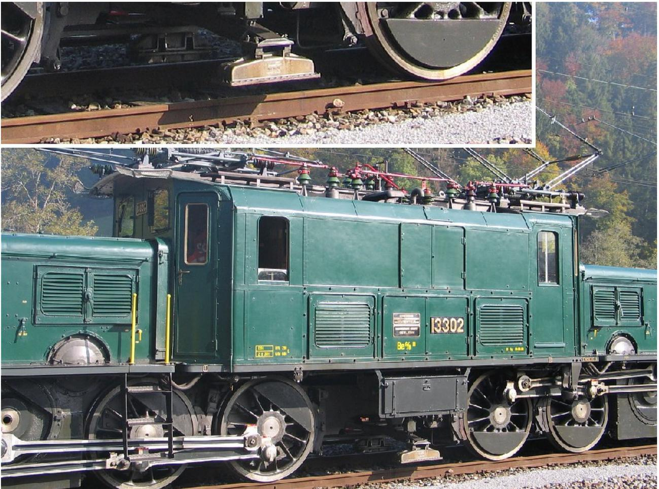
ci-dessus : capteurs « signum » d'une célèbre machine CFF.
