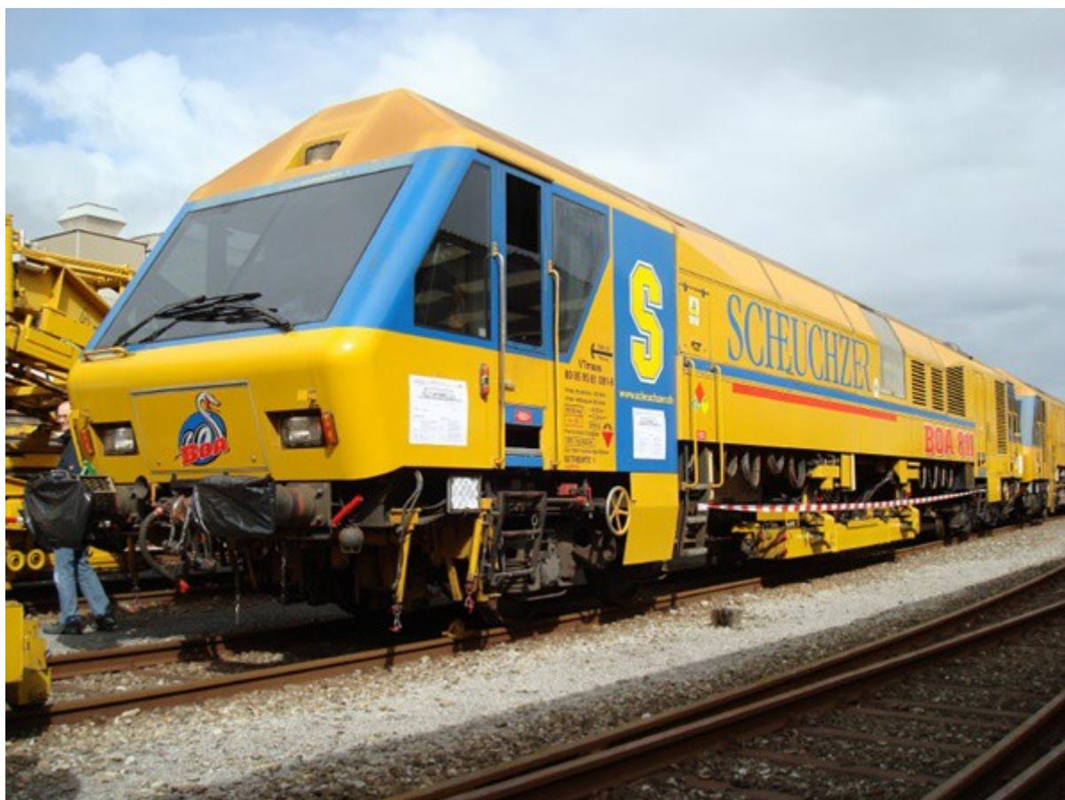
L'automotrice qui assure les opérations inhérentes au remplacement des rails, soudure , meulage des soudures, libération des contraintes dans les rails, chauffage des nouveaux rails, installation de ceux-ci et fixation, convoyage des anciennes et des nouvelles attaches.
