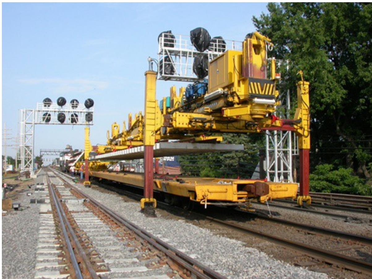
Ensemble d'engins complètement autonomes, destinés à la pose d'un appareil de voie monté préalablement dit "monté à blanc", en une ou plusieurs parties suivant sa longueur, ce matériel assure le chargement et le déchargement de l'appareil, les déplacements latéraux et longitudinaux, la pose, que ce soit sur voie existante ou non. Ce système a un caractère universel permettant son utilisation dans le cadre de travaux de substitution de voie.
