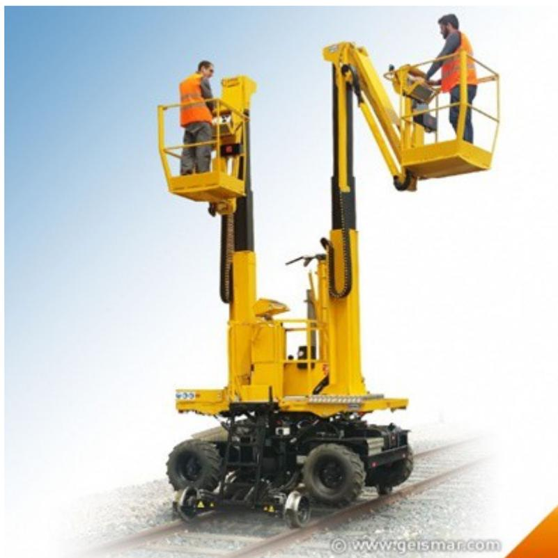
Cet engin est composé de nacelle permettant aux ouvriers d'atteindre la hauteur des fils.
