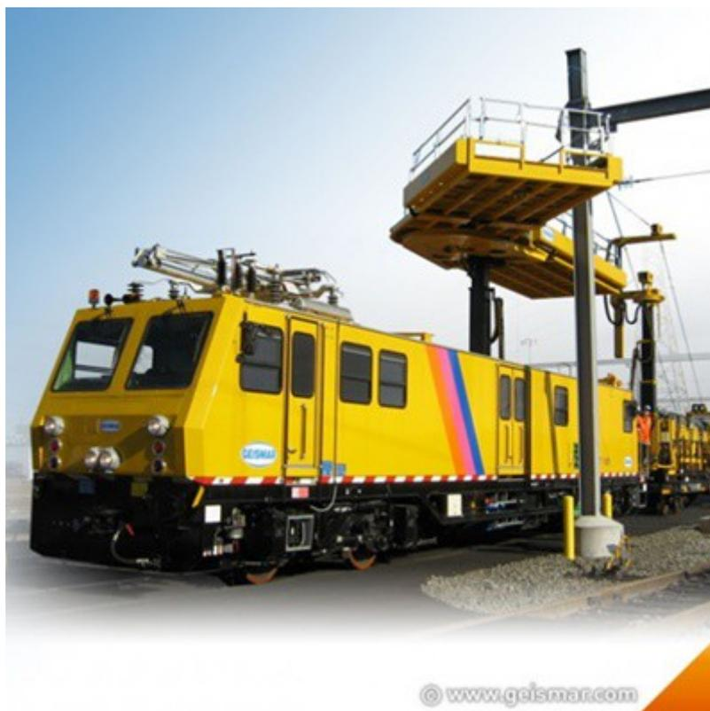
Cette draisine a puissance élevée de 640 à 900 ch permettant jusqu'à 120 km/h et la traction de 400 t à 60 km/h ou de 160 t à 20 km/h en rampe de 25‰, et plus en unités multiples. Le châssis de 18 à 23 m monté sur 2 bogies offre de nombreuses possibilités de configurations selon les constructeurs et la demande du client. Il y a deux postes de conduite.
