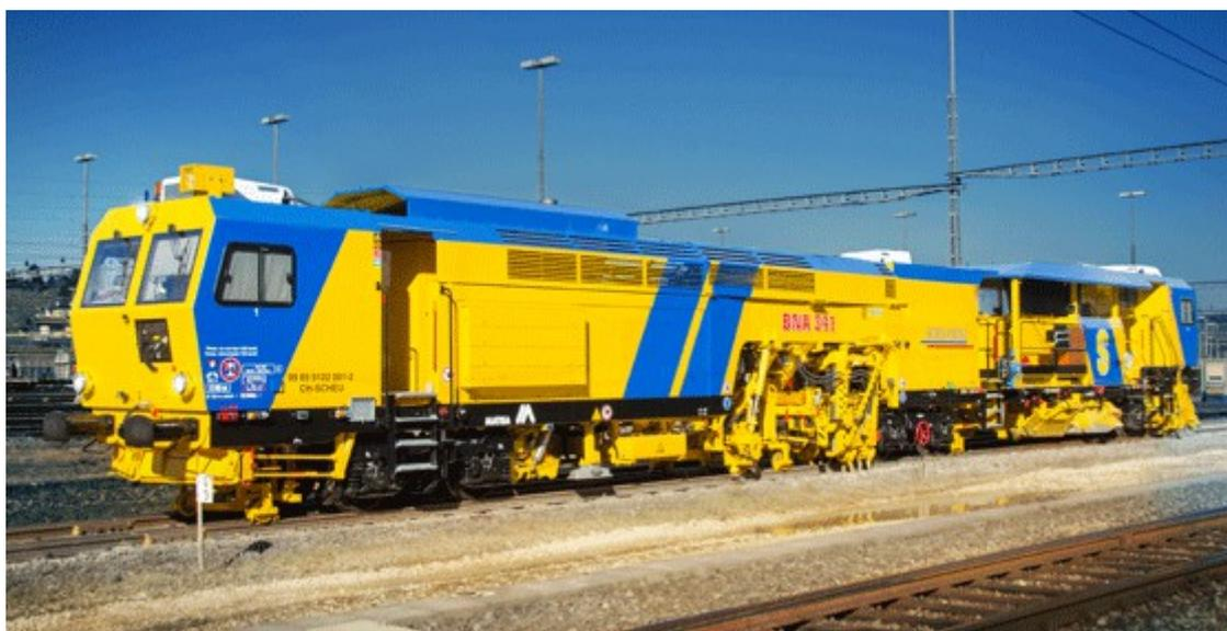
Les bourreuses dresseuses mécaniques de dernière génération se composent de trois modules formant un ensemble de 25 mètres environ.
