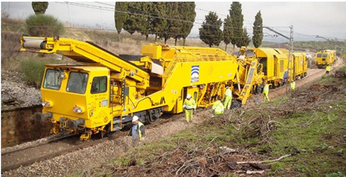
Celles équipées de criblage montée sur bogies équipée, d'une part, de dispositifs permettant de soulever la voie, et, d'autre part d'outils, qui, sous cette voie surélevée, enlèvent le ballast pollué de la plate forme, et procèdent à son criblage, les éléments de granulométrie adéquate sont remis dans la voie. Les machines modernes effectuent de multiples fonctions et c'est grâce aux divers perfectionnements hydrauliques et électroniques que ce matériel peut réaliser :
