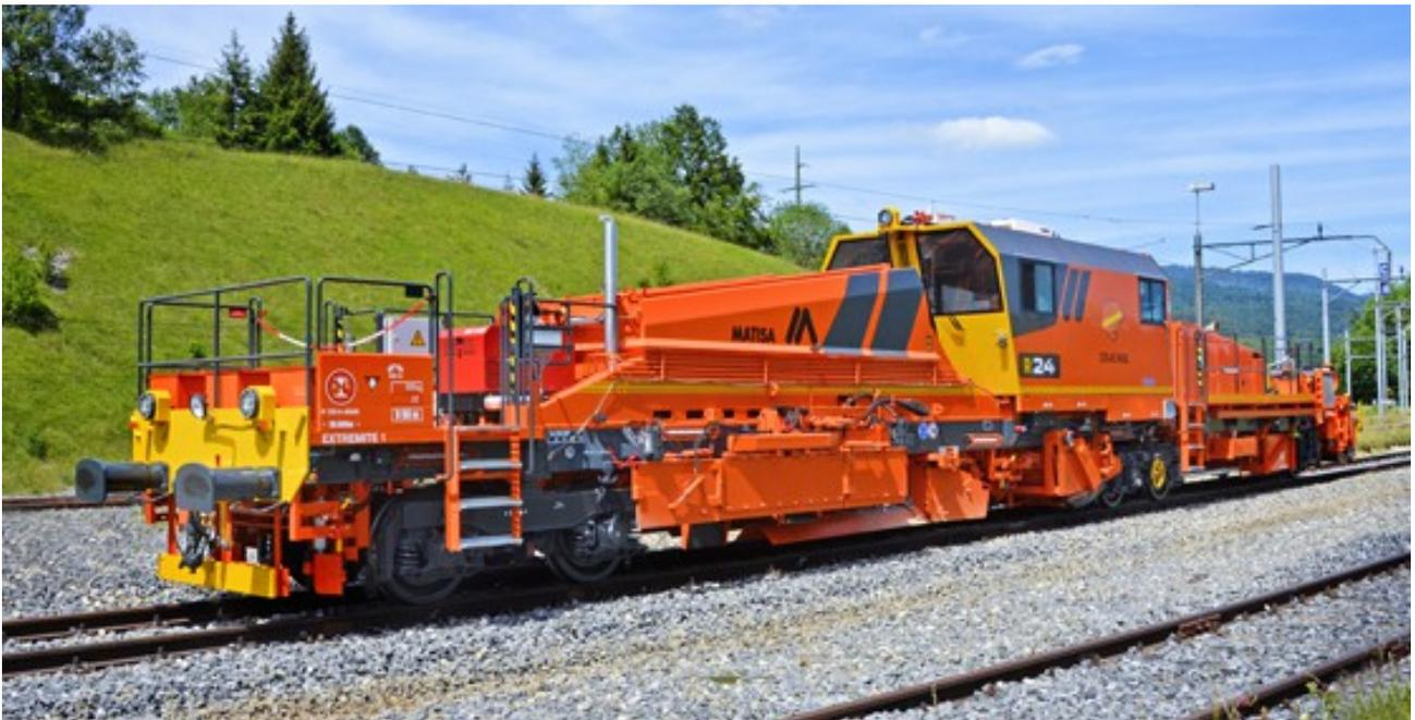
Cet engin automoteur équipé d'un moteur de 250 à 400 cv exécute la répartition du ballast déchargé lors des travaux de construction ou d'entretien des voies en respectant les profils réglementaires.
