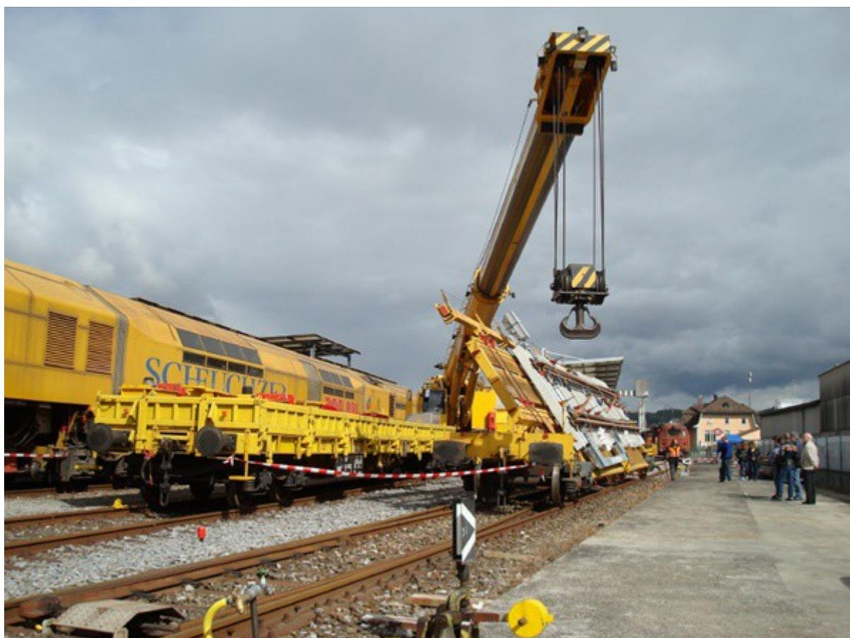
Engins automoteurs, équipés d'une ou deux grues hydrauliques, utilisés pour la manutention de panneaux de voie ou d'appareils de voie. Ils sont exploités en ligne, dans le cas de chantiers exécutés sur double voie pour le transport de rails, de panneaux de voie, d'appareils de voie, ou en gare sur les voies de service (pour le chargement ou le déchargement des matériaux venant des chantiers).
